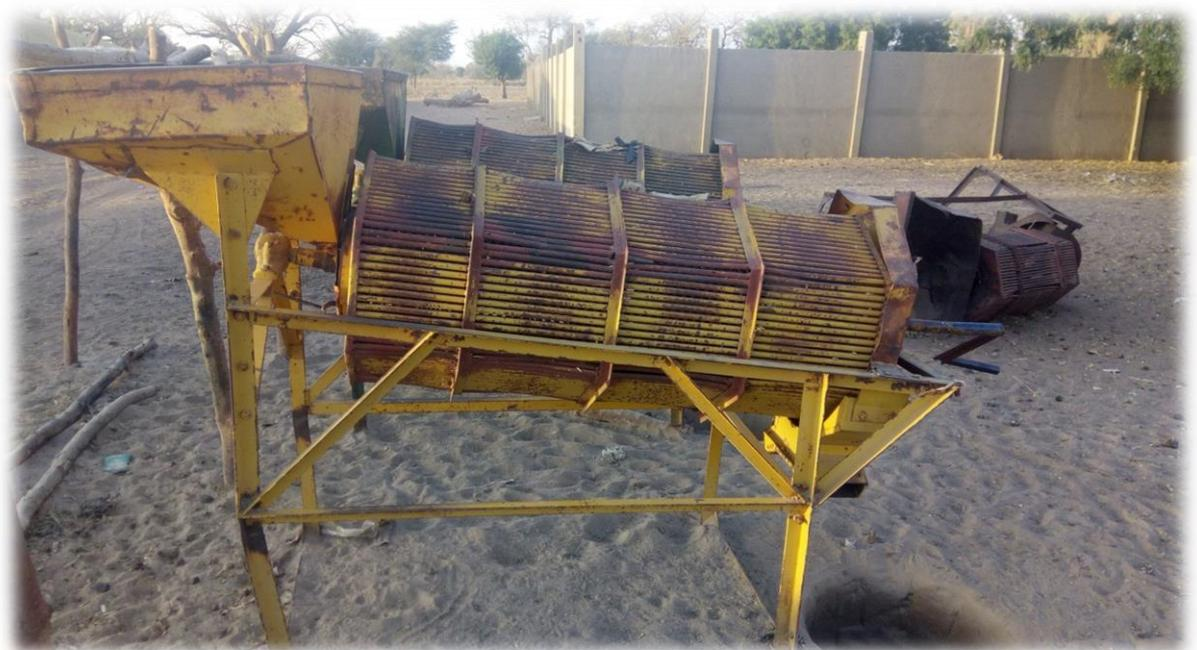
Voici une machine à main qui permet d'égrener quelque petite quantité d'arachide utilisée en cuisine par les ménages.
